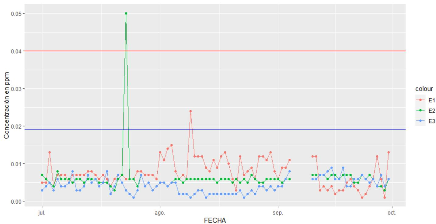
Figura 26. Serie de tiempo de SO<sub>2</sub> para las tres estaciones de CFE
