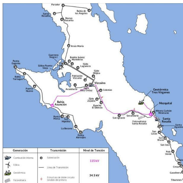
Figura 17 Sistema Eléctrico de Mulegé
